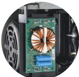
วงจรกรองสัญญาณรบกวน แบบกึ่งอวกาศแบบวงจรหลัก
